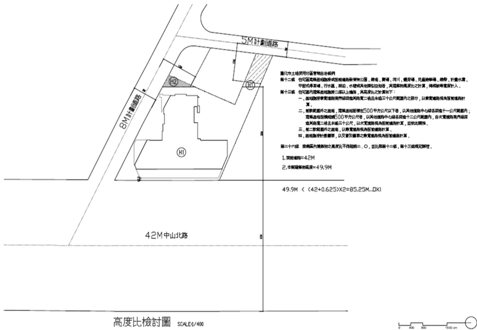
圖 10-20 建築物高度比檢討圖(S: 1/400)
